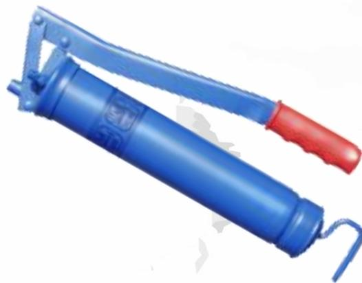
*Remplissage par cartouche de graisse ou par aspiration de graisse en vrac.
